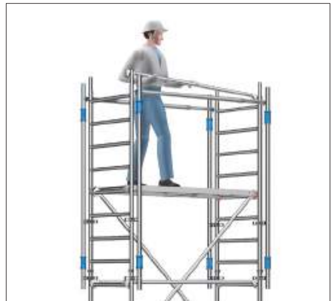
Fig. 6: Colocación segura de las barandillas con AGS
