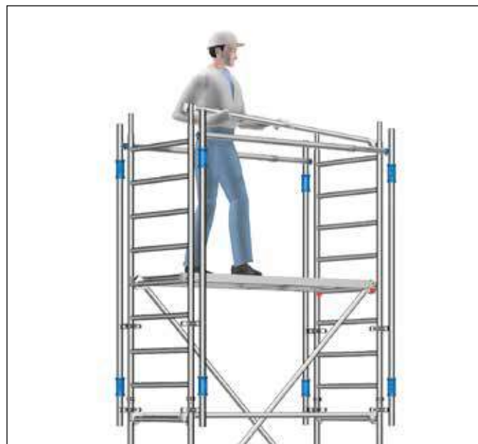
Fig. 6: Colocación segura de las barandillas con AGS
