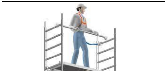
Fig. 3: Colocación de las barandillas con EPI
