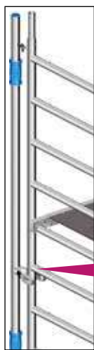
Fig. 4: Conexión del mástil al marco
