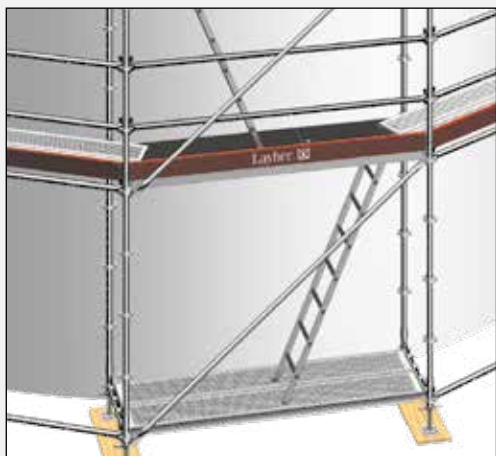
Colocación de la plataforma Robust con trampilla de apertura lateral 15 .
